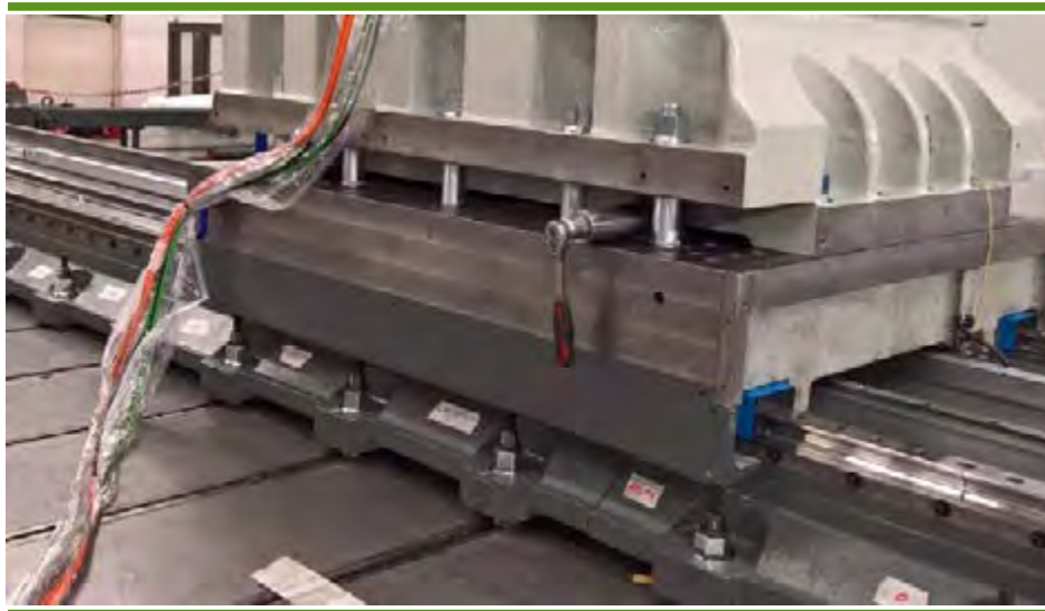
Fig 4. Se asegura un correcto montaje de las columnas.
