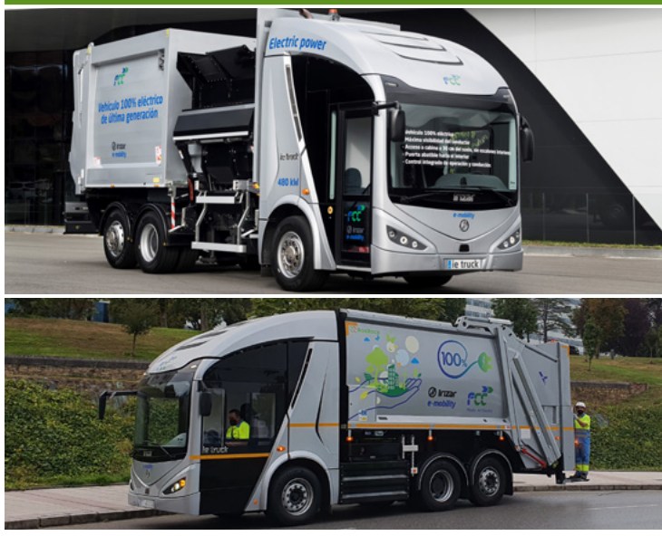
Chasis plataforma 100% eléctrico ie-urban truck, recolectores de carga lateral y de carga trasera
