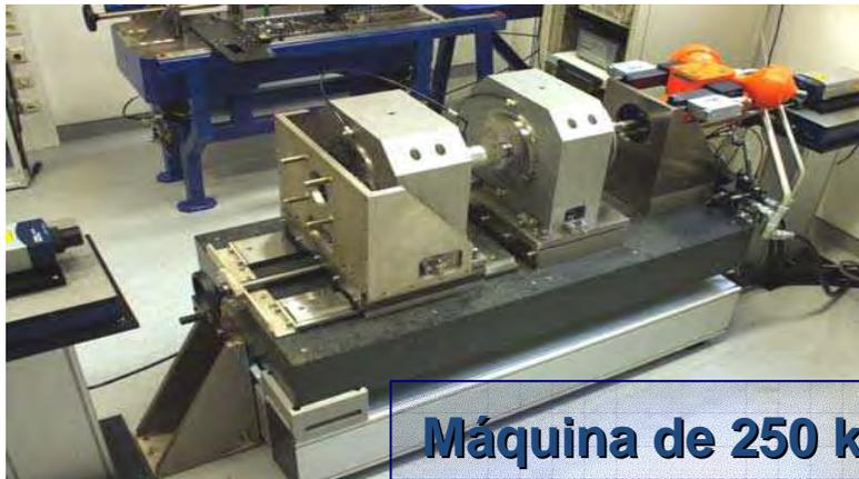
**Máquina de 250 kN con cojinetes neumáticos**
