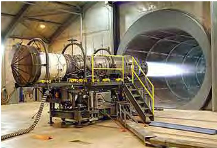
Ensayos de turbinas
