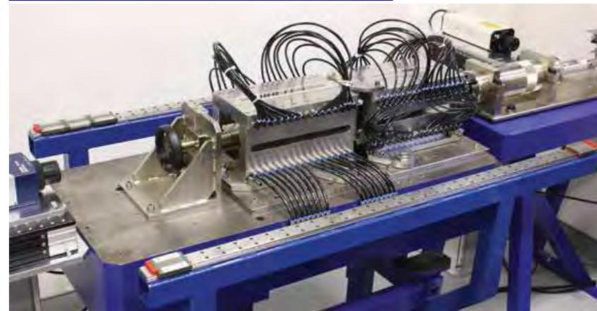
**Máquina de 20 kN con guías lineales**
