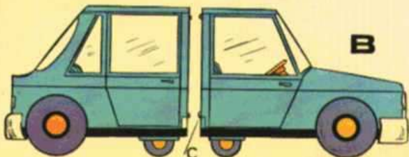
LAS DOS MITADES SEPARADAS ESTÁN SE ACOPLAN O SE SEPARAN POR LOS ENCAJES (C)
