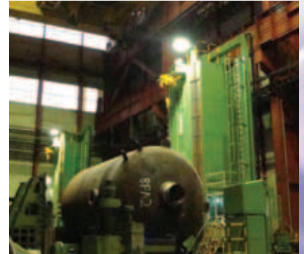
Foto 1. Puntos de luz nuevos cerca de la zona de trabajo.
