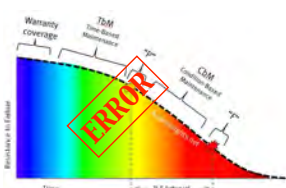
La condición no decrece porque pase la garantía. El PM o PdM no se aplican simultáneamente. El PM no detecta fallos. F y CF no son el mismo punto.
