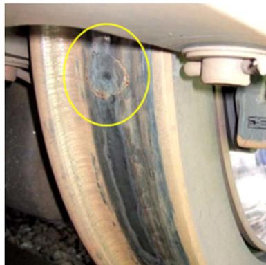
Figura 1. Ilustración de un plano de rueda [1].
